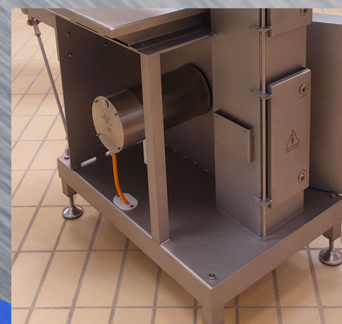
Motore autofrenante inox IP69K
