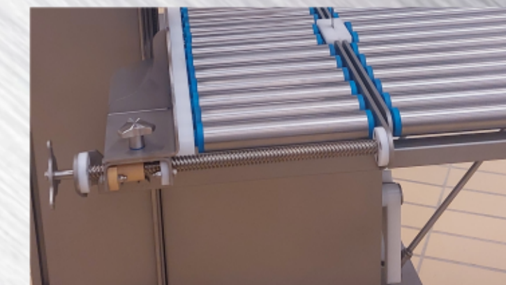
Regolazione taglio con movimento a vite e battuta asportabile
